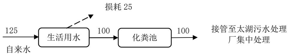
图 2-2-1 本项目实际水平衡图 单位 t/a
