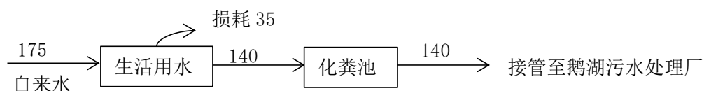
图 2-2-1 本项目实际水平衡图 单位 t/a
