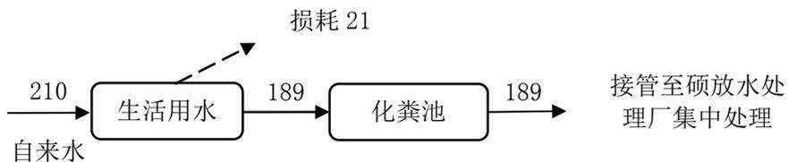
图 2-2-1 本项目实际水平衡图 单位 t/a
